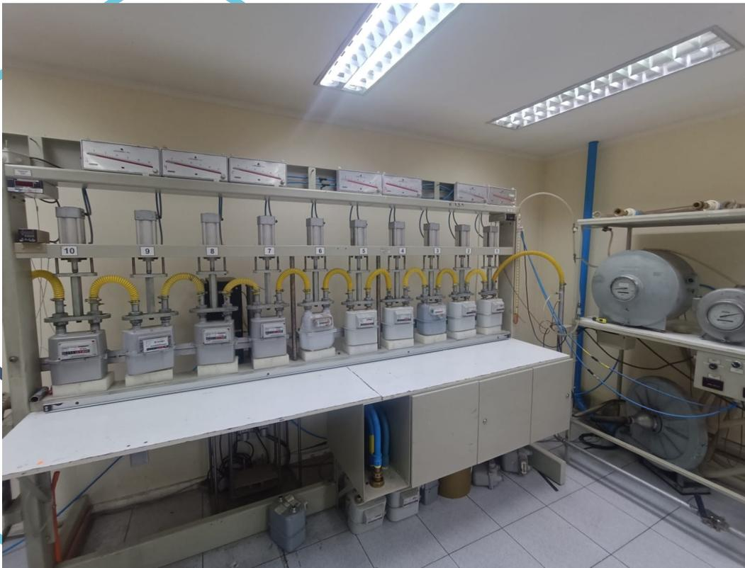
Laboratorio de Ensayo para Medidores de Gas Usados. ÁREA COMBUSTIBLE
